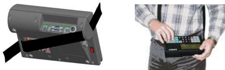
Рис. 4.5 - Крепление ремня для переноски терминала RC
