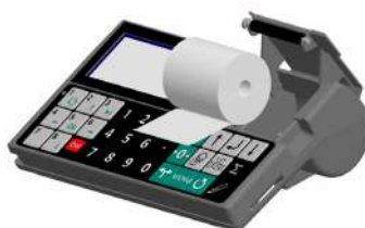
Рис. 4.6 - Заправка бумаги в терминал RC
