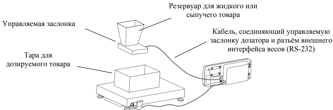
Рис. 7.2 - Подключение весов к дозирующему устройству
